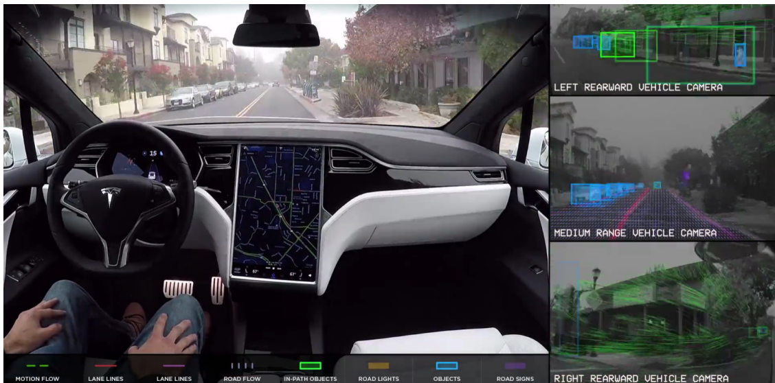
Слика 1.1: Пример функционисања Теслиног аутопилота
